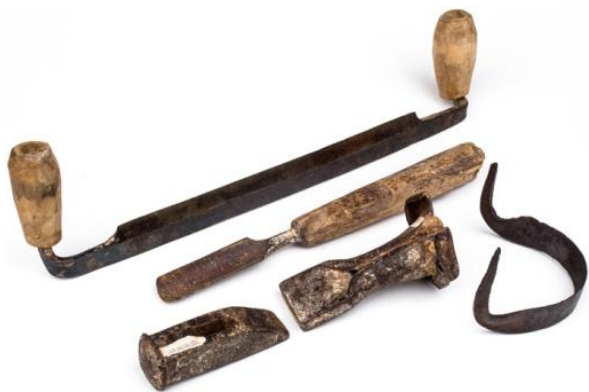
Рис. 4. Бондарные инструменты: скобель прямой и кривой, резец, бойковая часть молотка, набойка. Начало XX в. Принадлежали жителю с. Верхнетамбовское В.И. Ешкову. Из фондов ХКМ им. Н.И. Гродекова
